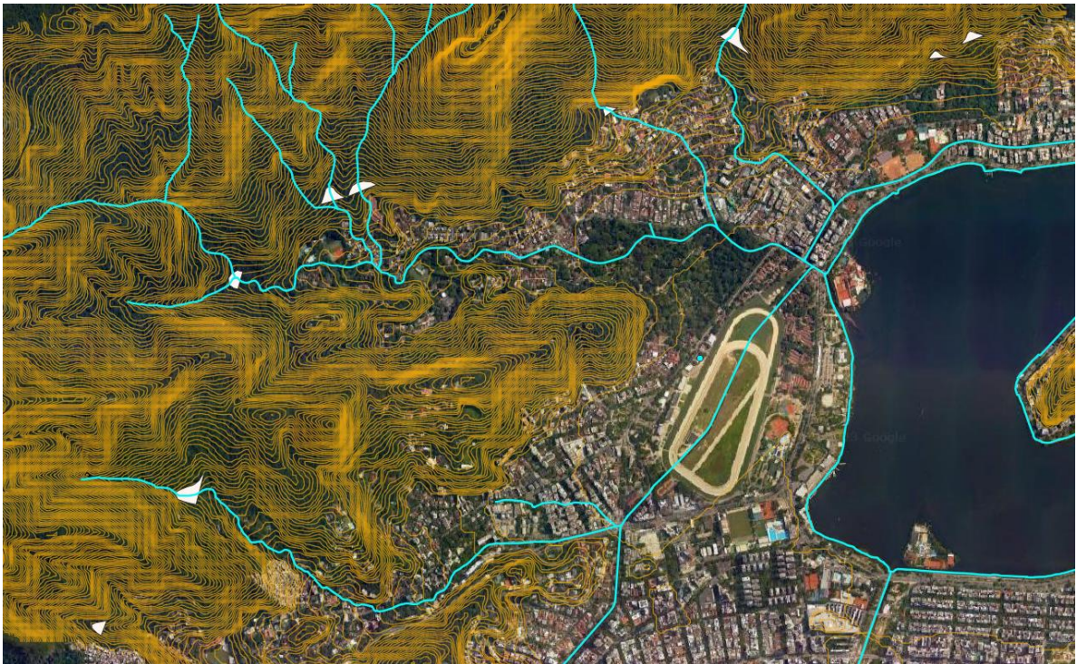
Figura 61 - Indicação das áreas de armazenagem temporárias (Reservatório de encosta) na Bacia do Rio dos Macacos com as curvas de nível.
