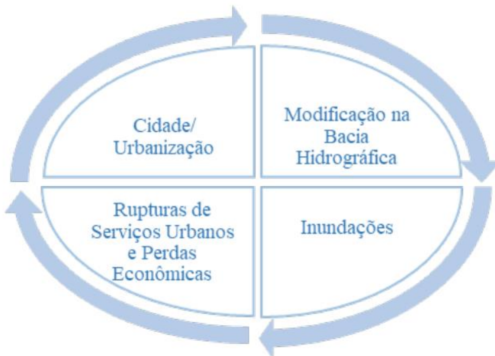
Figura 4 – Ciclo de degradação ocasionado pelo inadequado processo de urbanização sem contar o sistema de manejo de águas pluviais Fonte: Oliveira (2018)
