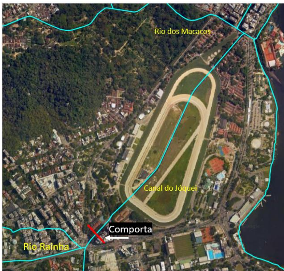
Figura 56 – Posição para a comporta que separa as bacias do Rio Rainha e do Rio dos Macacos.
